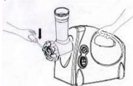
Аккуратно снимите дисковый и режущий ножи, при необходимости, поместив отвертку между дисковым ножом и горловиной.
