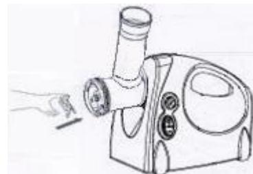
4. Помістіть потрібний дисковий ніж попереду ріжучого ножа, поєднавши виступи на дисковому ножі з віймками на горловині.
