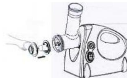
3. Плотно закрутите накатную гайку, но не затягивайте ее сильно. Установите лоток на горловину и зафиксируйте его.
