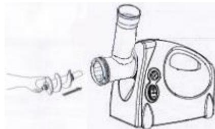
3. Установите нож на шнек режущей стороной наружу. Если нож установлен неправильно, мясо не будет измельчаться.
