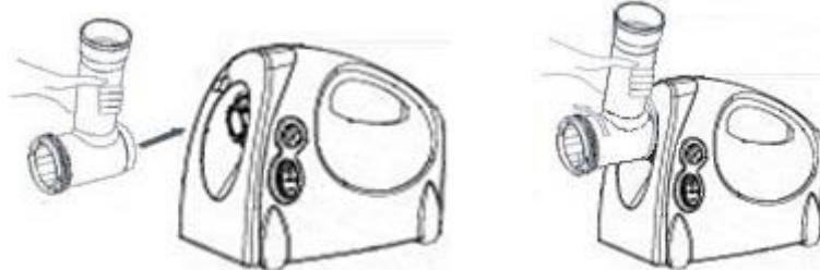
2. Поместите шнек в горловину, слегка поворачивая его до тех пор, пока он не встанет в корпус моторного блока.
