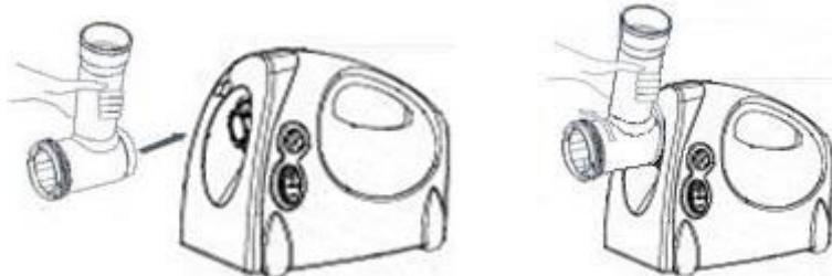
2. Помістіть шнек в горловину, злегка повертуючи його до тих пір, поки він не встане в корпус моторного блоку.
