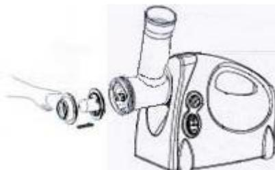
3. Щільно закрутіть накатну гайку, але не затягуйте її сильно. Встановіть лоток на горловину і зафіксуйте його.
